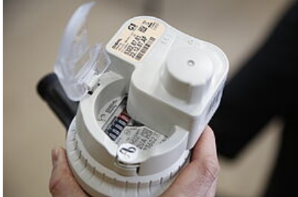
Compteur d'eau équipé de la télérelève
