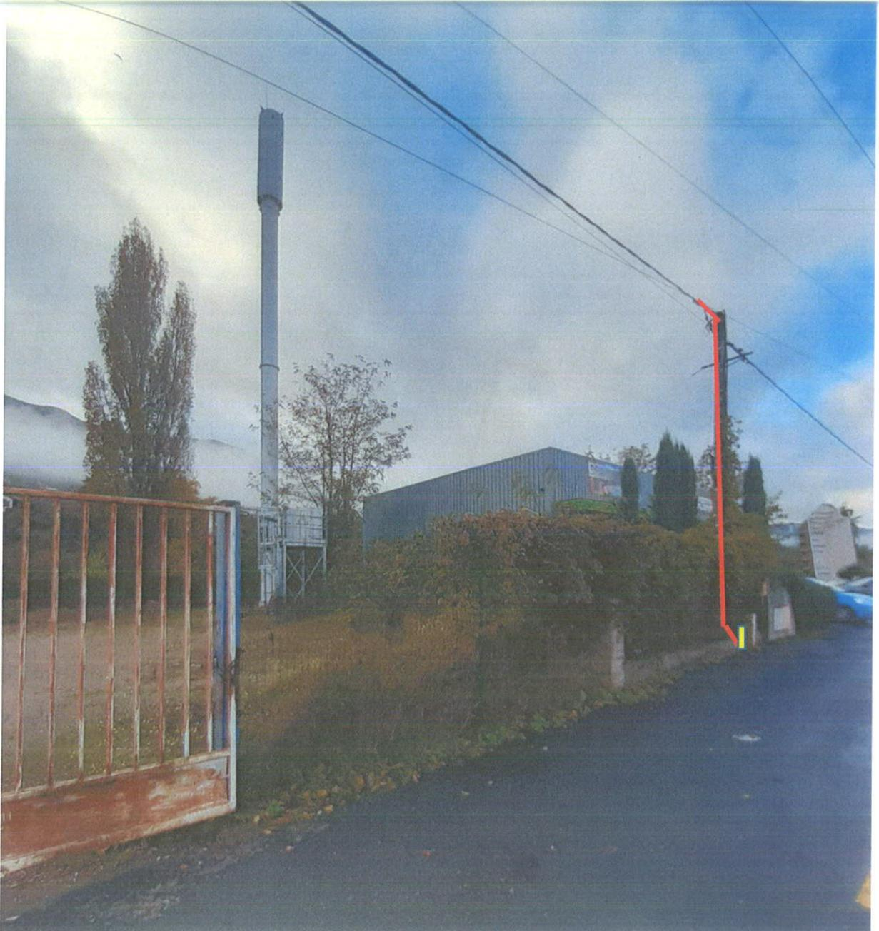
Réaliser un raccordement aérosouterrain triphasé type 2. Prévoir un mètre de terrassement en T1 du parcelle DB 64 appartenant à la mairie (convention).
