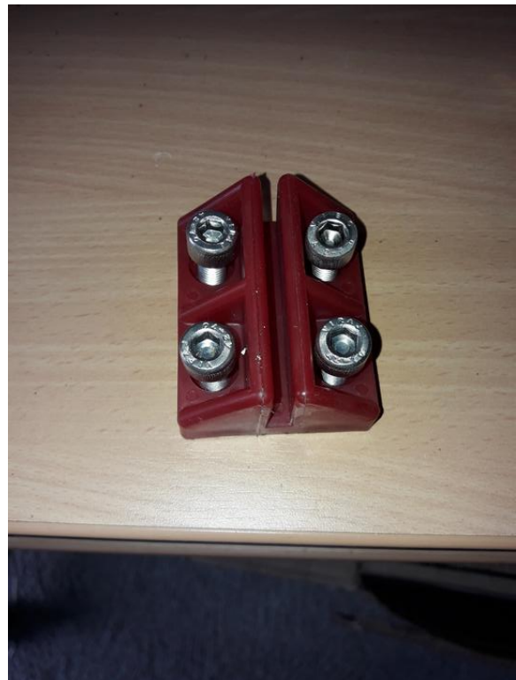
Remplacement des coulisseaux des systèmes de dégrillage
